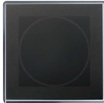
Quickfit 1 feu grand modèle Vitrocéramique : 500 x 500 mm, épaisseur 6 mm Cadre inox : 528 x 528 mm Découpe dessus : 480 x 480 mm
